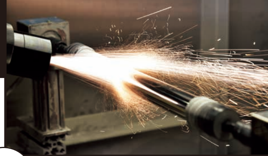
[ AL溶射工程 ]
